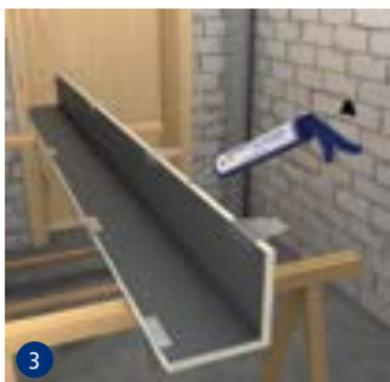
Ponter les joints de panneau de l'élément d'angle swissporBOARD à l'aide du mastic d'étanchéité et de la colle hybride swissporBOARD.
